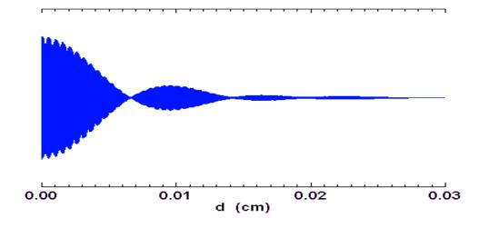
L'enregistrement de I(M) permet de remonter à la largeur de la raie spectrale.
