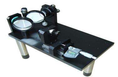
L'interféromètre de Michelson pratique couramment utilisé dans les laboratoires des lycées. Il est constitué d'élément optiques de qualité :
